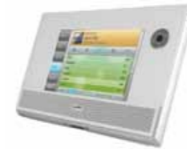
Portables Wireless-LAN Touch Panel für komfortable und mobile Bedienung.
